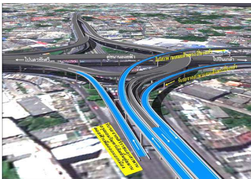
รูปที่ 9 ทางขึ้นทางคู่ขนานลอยฟ้า ขนาด 1 ช่องจราจร กับ Dead End Structure ที่สร้างไว้แล้ว
