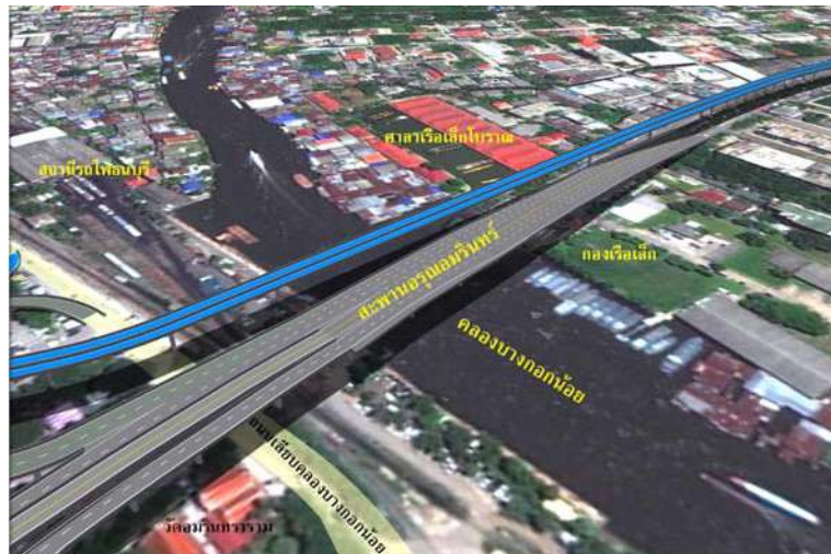
รูปที่ 6 ทางยกระดับของโครงการจะข้ามคลองบางกอกน้อยโดยไม่มีตอม่อในคลอง
